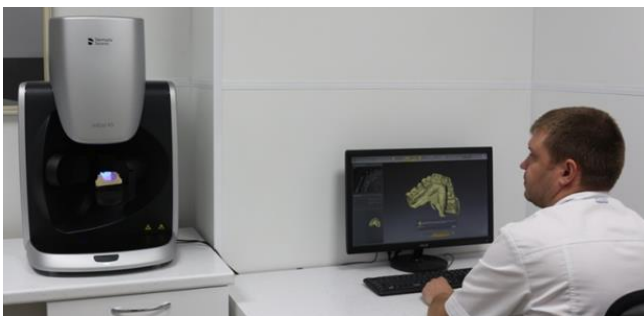
Рис. 3. Этап сканирования модели на аппарате CAD/CAM Inlab MC X5.
